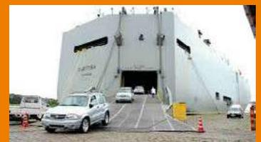
**Navios Roll-on/Roll-off (Ro-Ro):** São navios em que a carga entra e sai pelos seus próprios meios, através de rodas como os automóveis, ônibus, caminhões e trailers.
